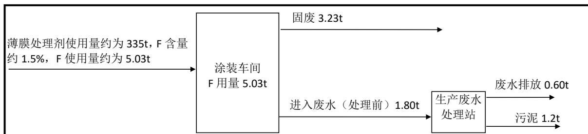
图 4-2-6 技改后涂装车间（二期）氟平衡图 单位：t/a
