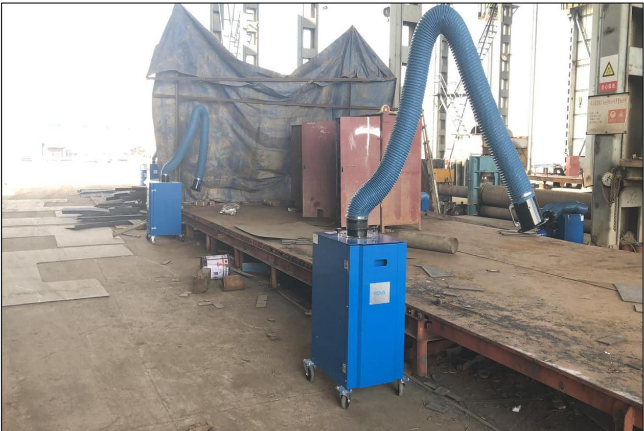
图 8-1-1 项目船棚设置移动式焊接烟尘净化器现状图
