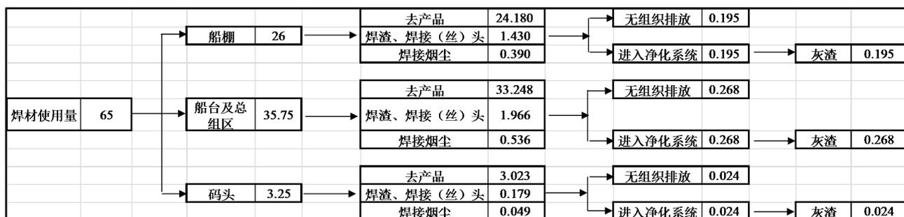
图 4-2-6 项目全厂焊材物料平衡图 单位：t/a
