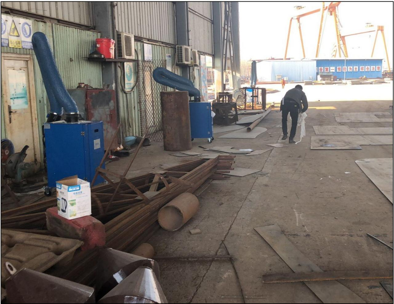
图 8-1-2 项目船棚设置移动式焊接烟尘净化器现状图
