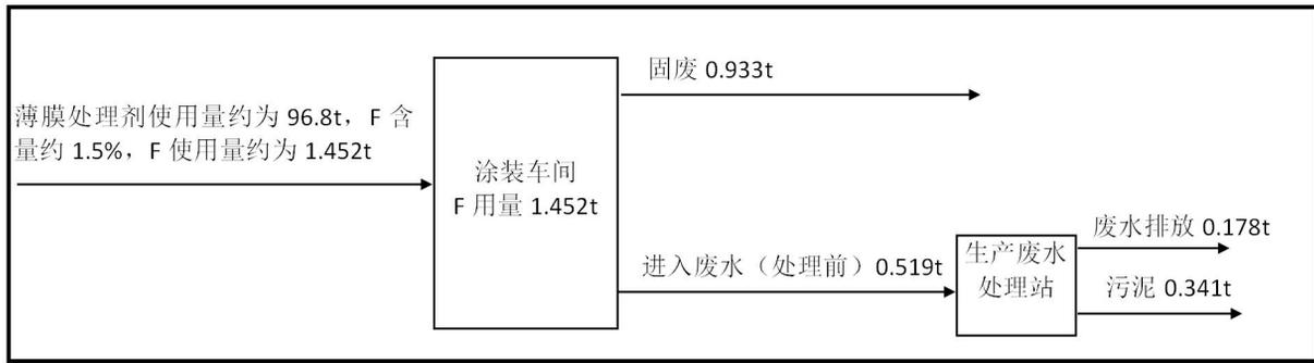
图 4-2-5 本项目新增车型 D2UC-2 及 D2UC-2 PHEV 氟平衡图单位：t/a
