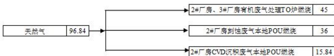
图 3.3-15 拟建项目天然气平衡图 (万 m 3 /a)
